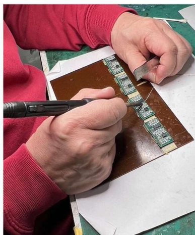
半田付け作業中
